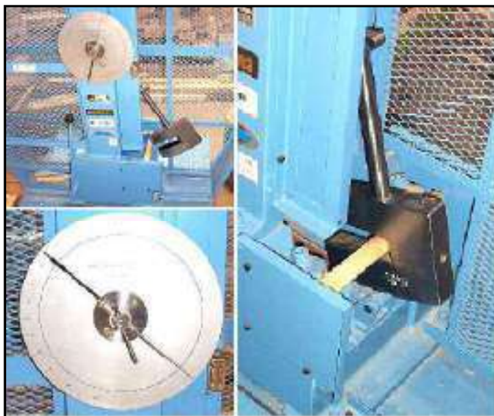
Figura N° 12: Ensayo de Resistencia al Impacto (Flexión Dinámica)
