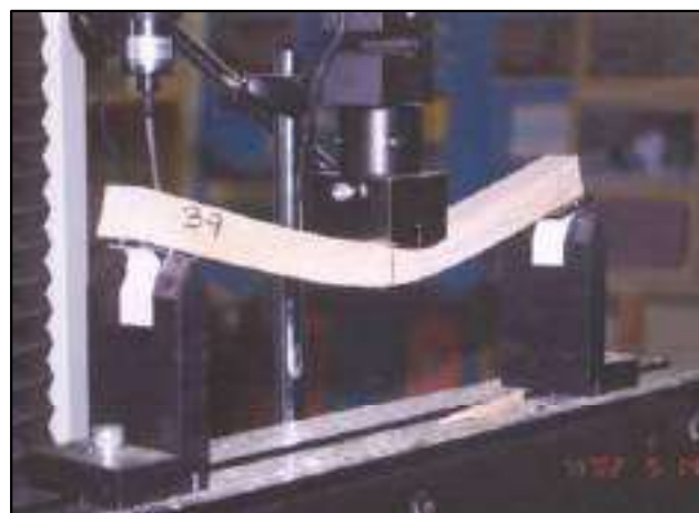
Figura N° 11: Esquema y ensayo de flexión estática en 3 puntos en máquina universal
